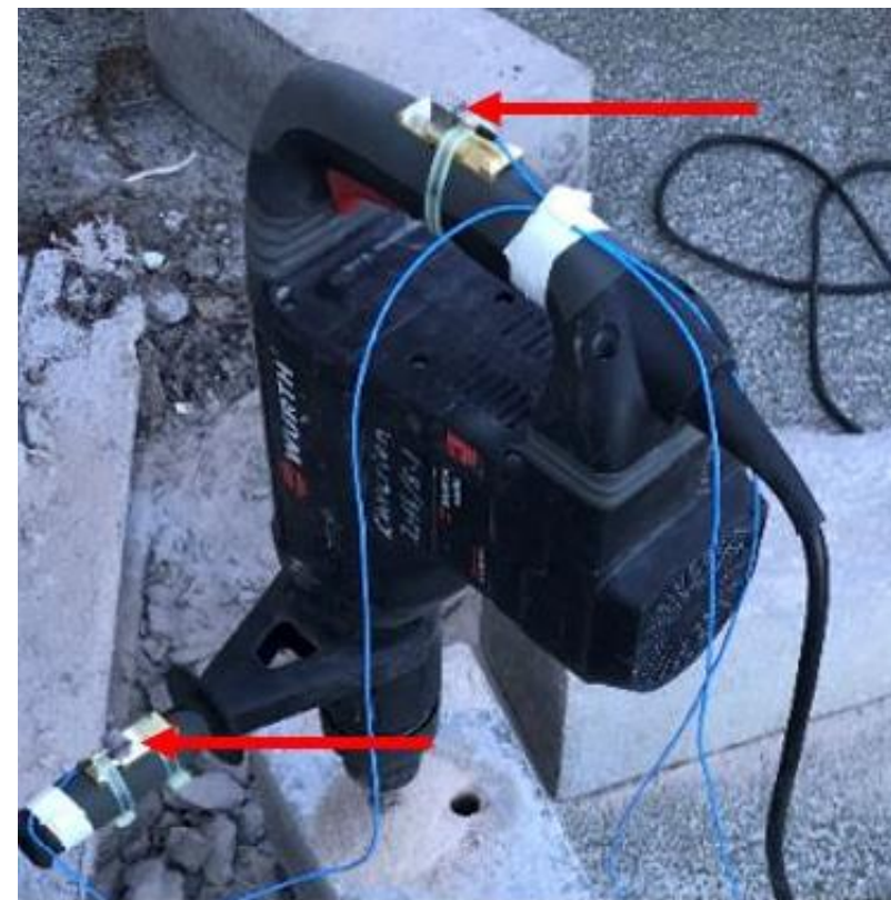
Målinger på Wurth BMH45-XE slagbormaskin
