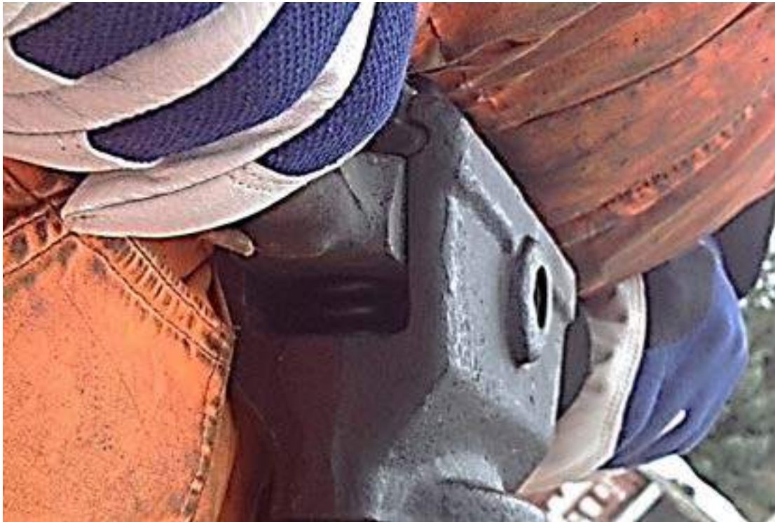
Vibrasjonsdempet håndtak med fjærbelastning på Atlas Copco RH 572 E
