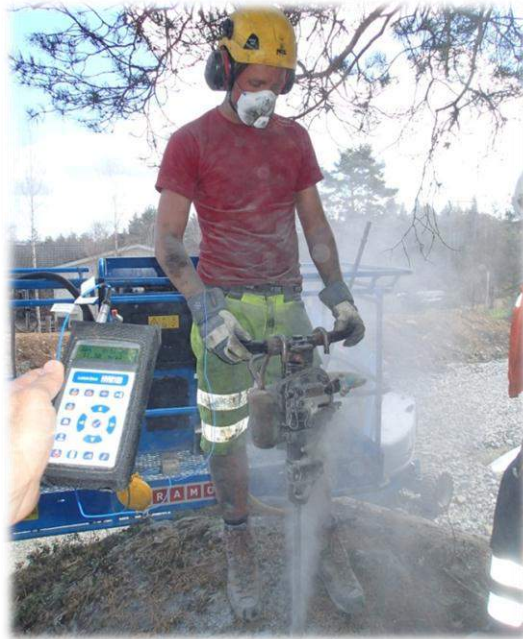
Vibrasjonsmåling av standardboring. Forundersøkelser i Kongsberg 07.05.2013
