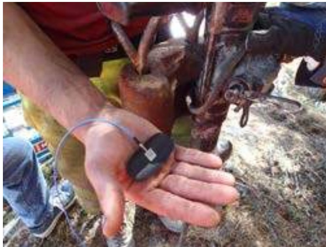
Plassering av akselerometer med hanskeadapter i operatørens hånd
