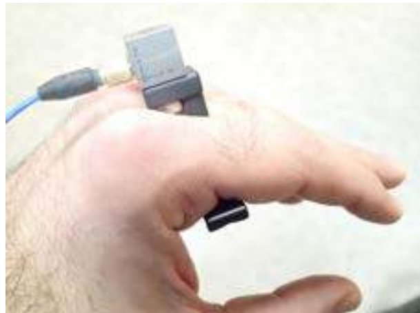
T-adapter med SEN21F tri-akselerometer med markering av akse-retning. Plassering er mellom peke- og langfinger.
